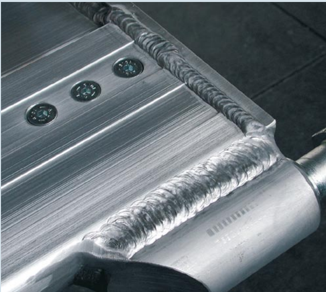
Bauteil aus AlMg4.5Mn, WIG-geschweisst mit SG-AlMg4.5Mn unter MISON®He 20
