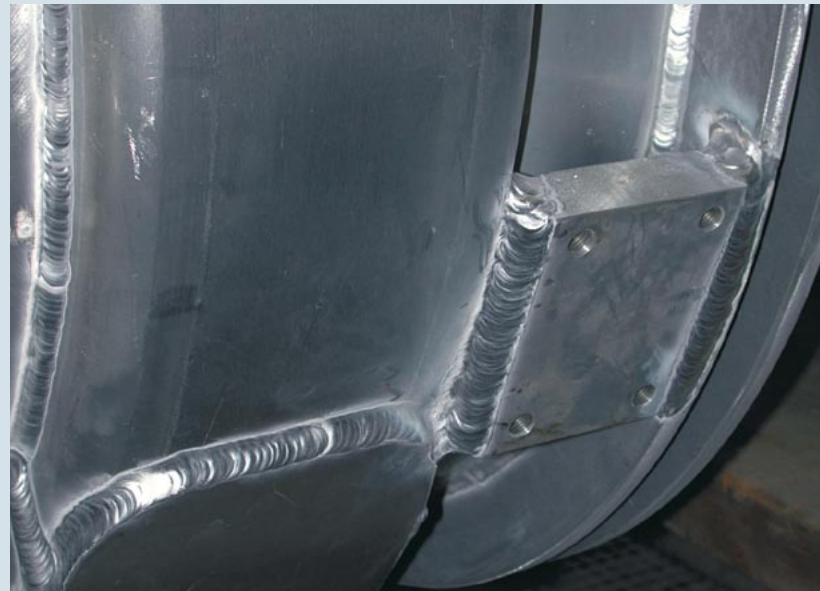
MISON®He 20: MIG-Schweisnaht an Aluminium-Behälter
