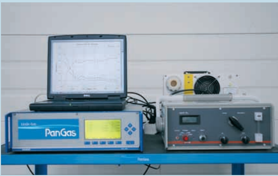
Analysensystem zur Messung der Ofenatmosphäre
