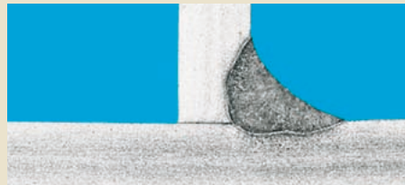
Kehlnaht mit Argon WIG-geschweisst
