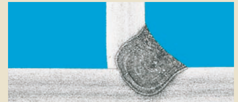
Tieferer Einbrand mit Argon-Wasserstoff-Gemischen
