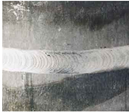
Keine Färbung: titan-stabilisierter CrNi-Stahl formiert mit HYDRARGON® 7
