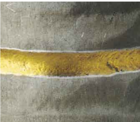
Typische Gelbfärbung: titan-stabilisierter CrNi-Stahl formiert mit Stickstoff
