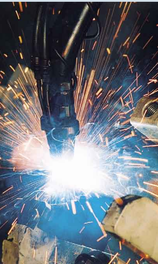
Gabelstapler-Hubmasten werden wirtschaftlich und mit sehr hoher Nahtqualität mit heliumhaltigen Schutzgasen geschweisst.
