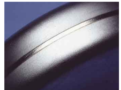
Mit einem Nd:YAG-Laser geschweißtes Gehäuse eines Herzschrittmachers
