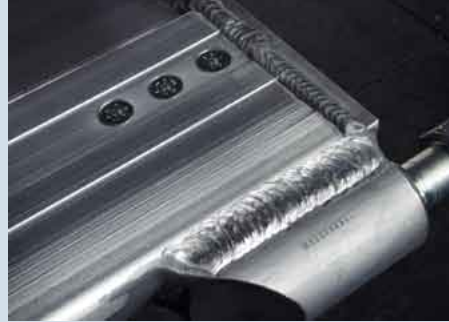
MISON® He 20: MIG-Schweisnähte an Fahrzeug-Aufbau
