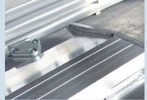
MISON® He 20: MIG-Schweisnaht an Aluminium-Werkstück
