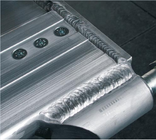
Composant en AlMg4.5Mn, soudage TIG avec SG-AlMg4.5Mn sous MISON®He 20
