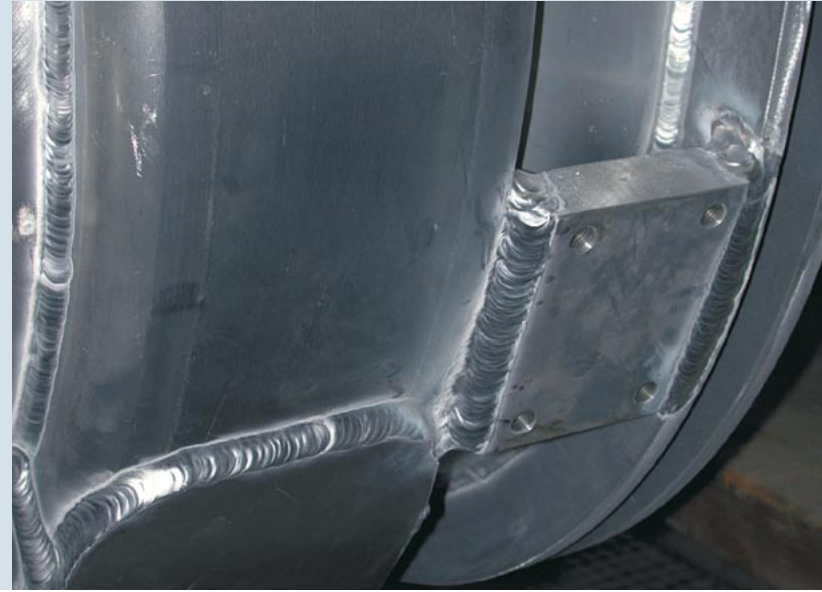
MISON®He 20: soudeur TIG sur un réservoir en aluminium
