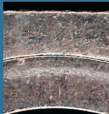
Etat de surface lors d'un traitement sous protection gazeuse à l'hydrogène pur
