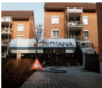
Remplissage d'un réservoir enterré
