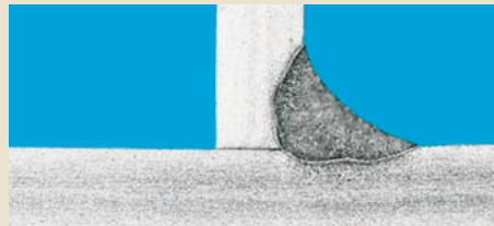
Soudure d'angle réalisée en soudage TIG sous argon
