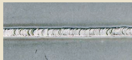
Envers de soudure protégé
