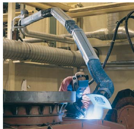
Aspiration dans la zone d'émission Photo: Nederman
