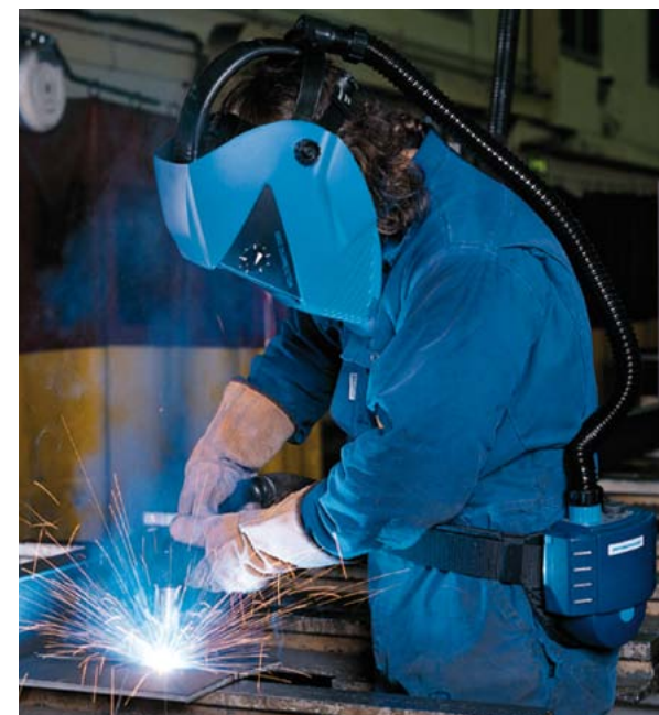
Casque de protection avec écran à ventilation extérieure Photo: Nederman
