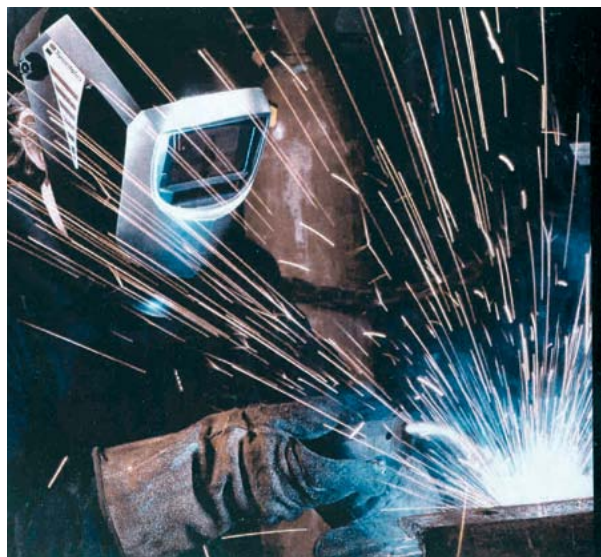
Protection des yeux par un écran Photo: Speedgas
