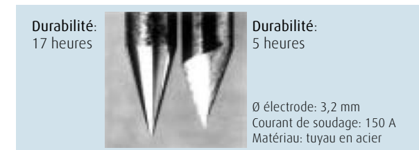
Effet de la rugosité et de la concentricité sur la durabilité des électrodes de tungstène
