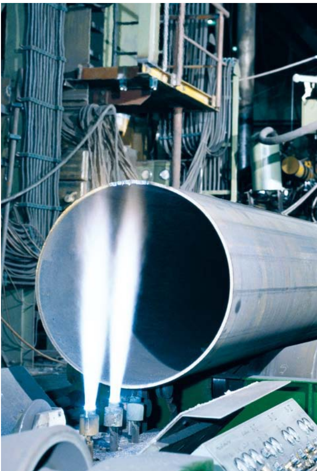
Figura 4.30 Impiego di un bruciatore speciale per righe termiche
