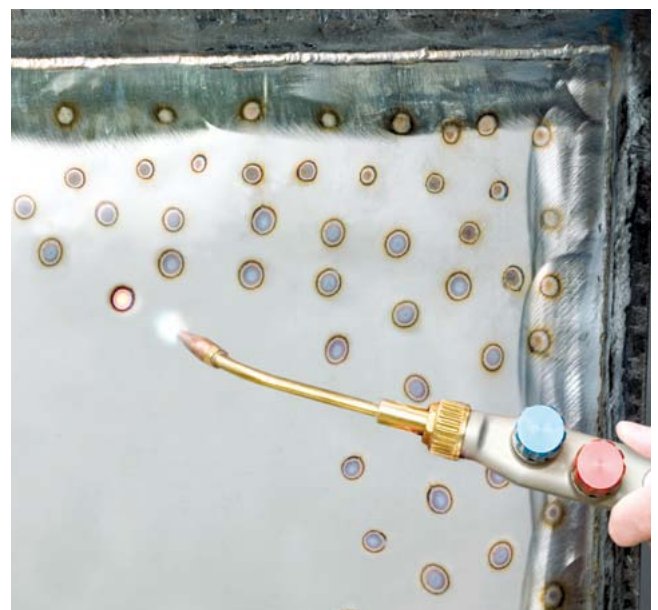
Figura 4.34 Raddrizzamento alla fiamma di una superficie di lamiera
