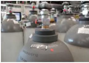
CO 2 -Flasche für gasförmige Entnahme (ohne Steigrohr)
