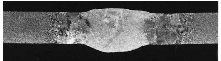
Abb. 6: WIG-Schweissnaht I-Stoss (Querschliff 4:1, Empa, Dübendorf)
