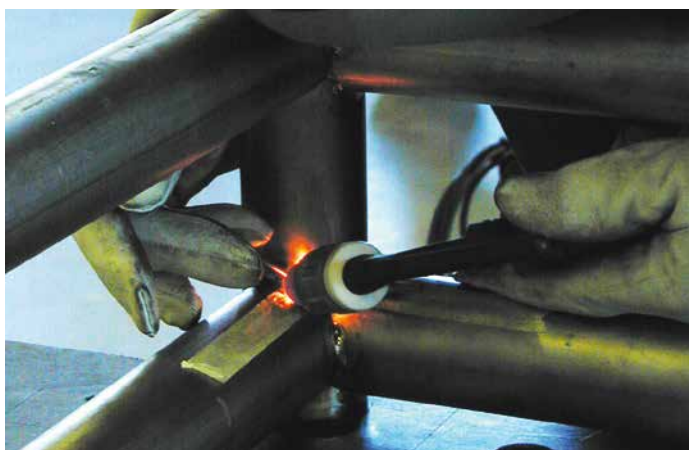
Abb. 3: Rohrkonstruktion aus Ti2 (INOX-Schweisstechnik, Zug)
