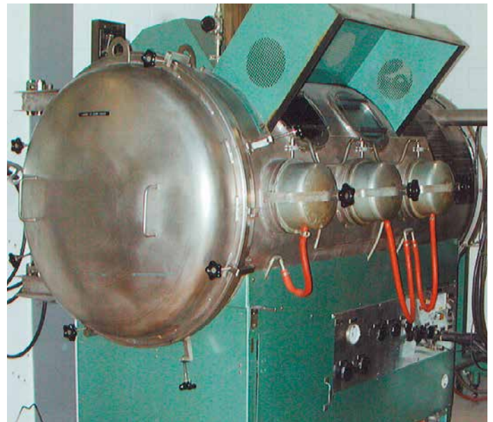
Abb. 4: Schutzkammer zum Schweißen reaktiver Metalle (RUAG, Emmen)
