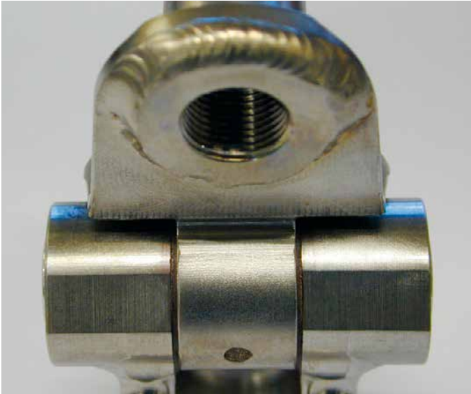
Abb. 2: Implantat aus Ti-6Al-4V (INOX-Schweisstechnik, Zug)
