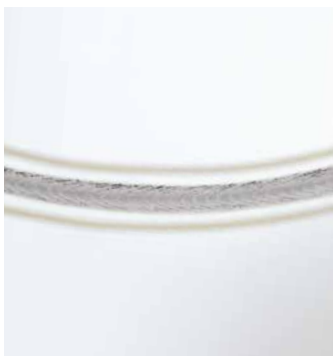
Photo 9: Altération typique de la couleur à côté du cordon, aussi appelé «Bistrage»
