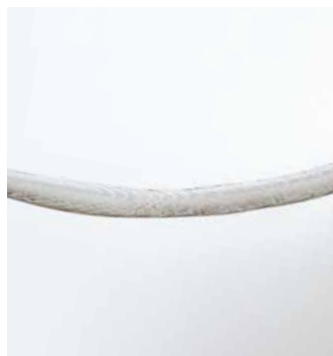
Photo 10: Cordon sans couche de dépôt grâce à un dispositif spécial «Bistrage»
