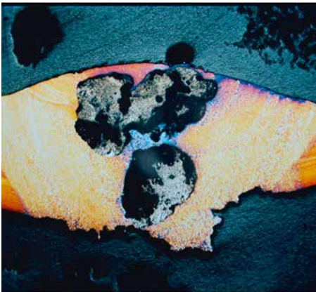
Photo 1: Corrosion par piquage avancée dans le métal fondu d'une soudure à l'arc TIG sur acier inoxydable (source: SLV Munich)
