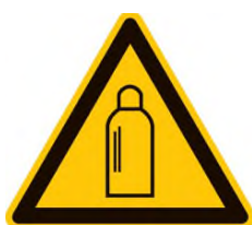
Attenzione bombole di gas
